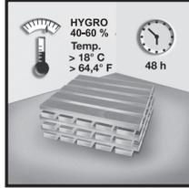
**Jeu permettant le travail du bois :** Sous l'effet des changements de l'humidité relative, les planchers stratifiés Golden Select prennent de l'expansion ou se contractent. Il faut donc laisser un jeu de 10 mm (3/8 po) autour du périmètre de la pièce et des objets fixes, et de 15 mm (5/8 po) pour les pièces dépassant 7,6 m (25 pi). Une fois le plancher installé, le jeu sera recouvert par les plinthes ou les quarts-de-rond.
